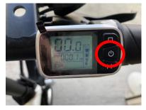
MIDモード、またはHIGHモードでは、 スロットルを回したり、ペダルを動かすと、 モーターが回ります。 意図しない発進を防ぐため、 運転席から降りる時や、 押して歩くなどの場合も、 必ず電源を切(OFF)にしてください。
